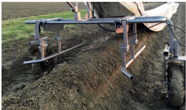
**(15 OP)** Système de guidage arrière pour arceaux / Slitta di direzione posteriore per archi / Führungsschlitten hinten für Bögen
