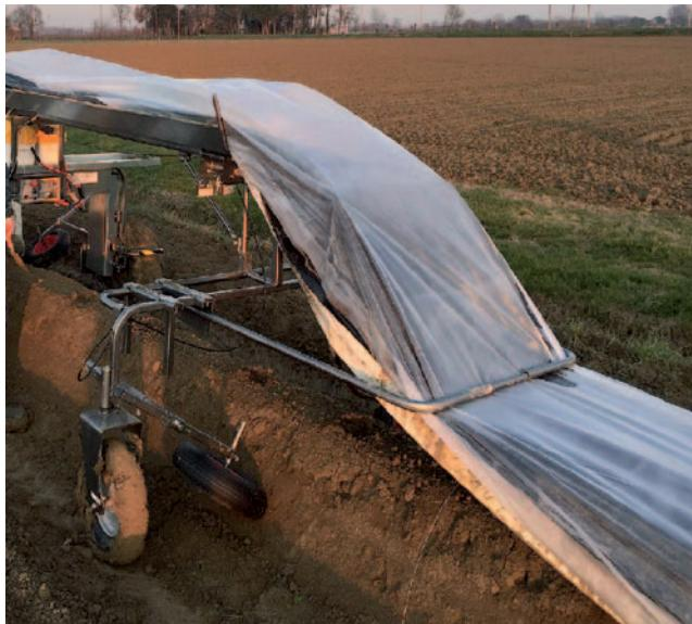
**(17 OP)** Protection contre le vent arrière / Antivento posteriore / Windschutzsystem hinten
