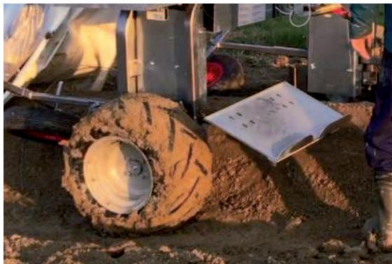
**(10 OP)** Pneus - Ruote - Bereifung 23.10/50-12
